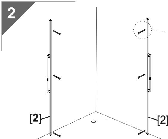
Профиль [2] по длине подрезается на монтаже
