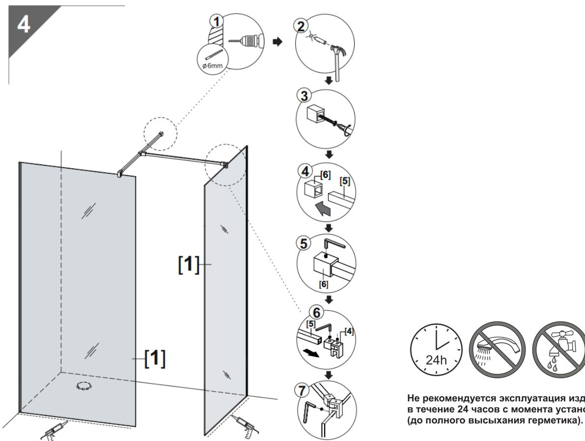
Не рекомендуется эксплуатация изделия в течение 24 часов с момента установки (до полного высыхания герметика).
